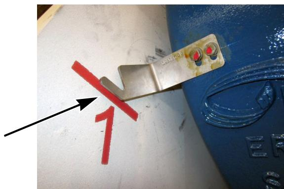
Abb. 33 Zeiger am Rotorlager (Beispiel)
