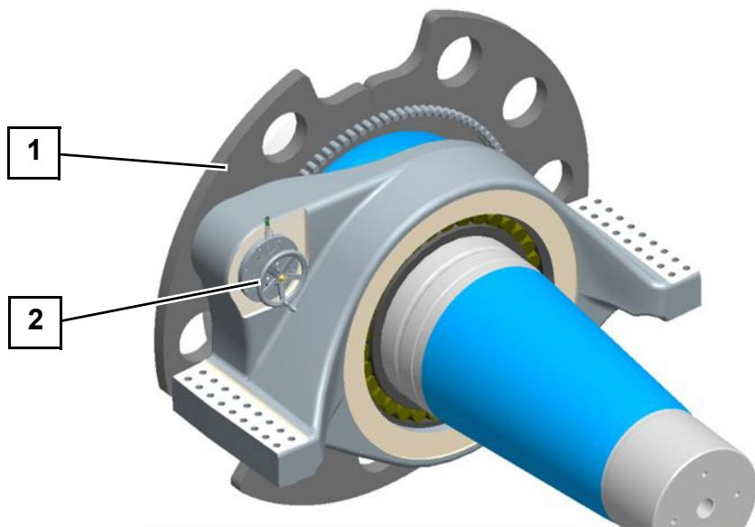
Abb. 29 Rotorarretierung an der Rotorwelle
