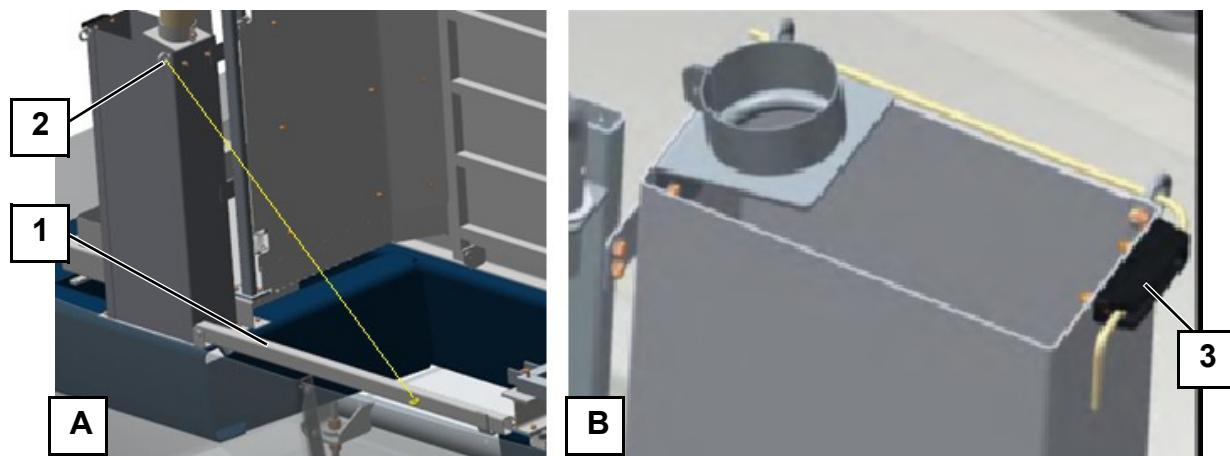
**Abb. 44** Auflagebalken geschlossen mit Perlonflechtleine (A) und Führung der Perlonflechtleine für Kranluke (B)
