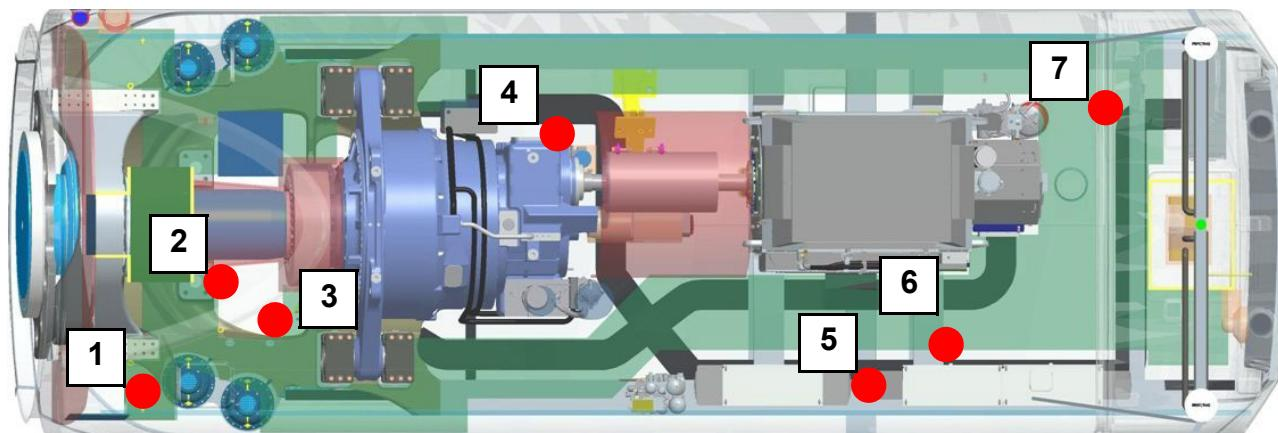
Abb. 12 Not-Halt-Schalter im Maschinenhaus
