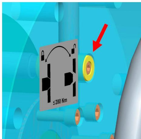
Abb. 36 Einstellhülse schließt bündig ab
