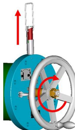
Abb. 38 Rotorarretierung entriegeln
