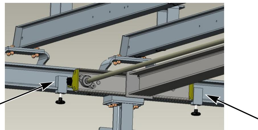
Abb. 46 Krananschläge für Brückenkran
