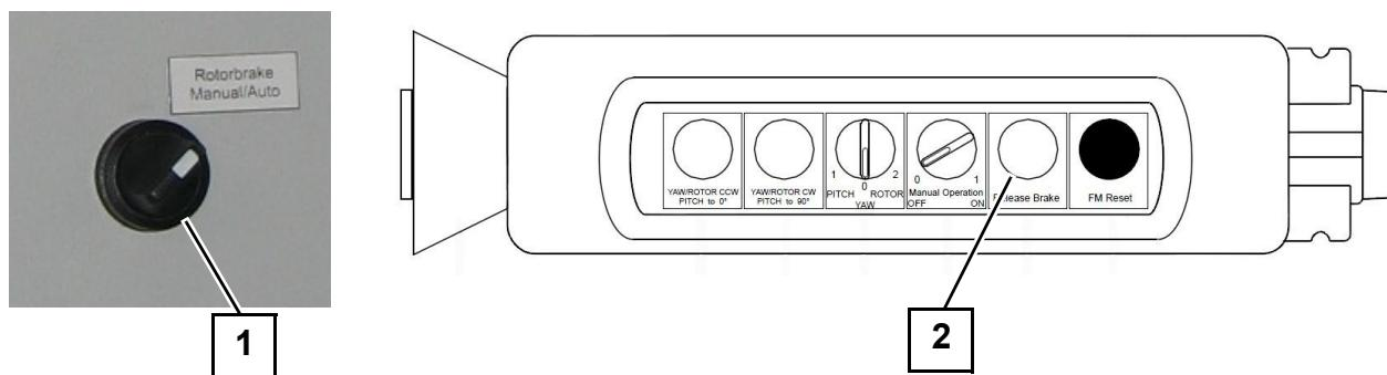
Abb. 17 Bedienelemente für manuellen Betrieb der Rotorbremse
