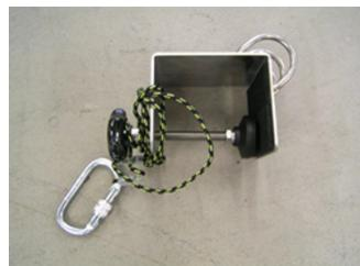
Abb. 21 U-förmiger Kantenschutz
