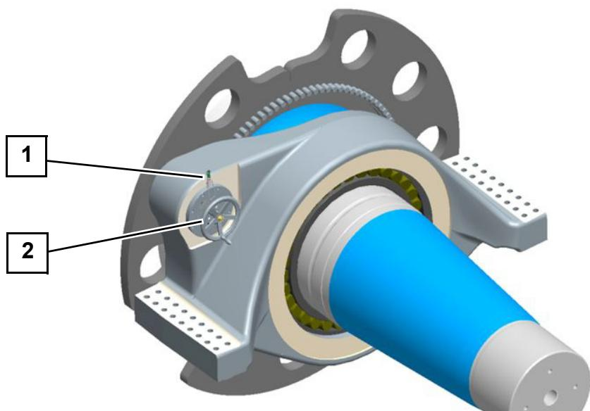
Abb. 34 Rotorarretierung an der Rotorwelle
