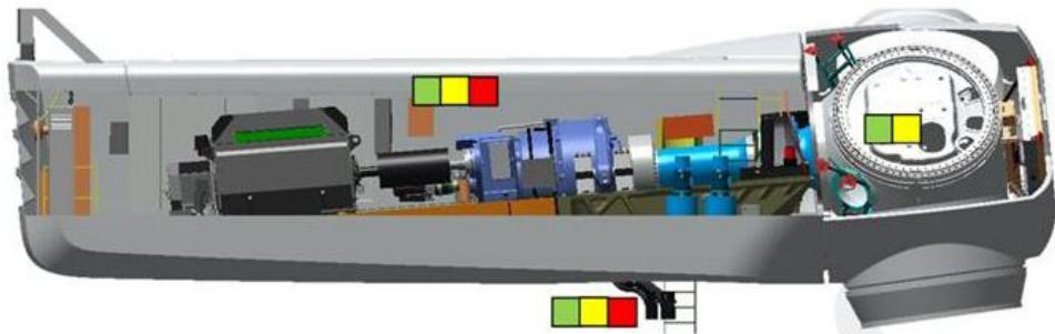
Abb. 13 Position der Signalleuchten
