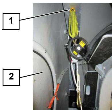
Abb. 20 Abseilgerät im Spinner, Beispiel Prototyp NXT 8.1/8.2
